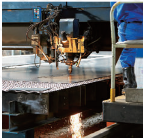
▲完成精度を上げるためにレーザー加工による精密切断。この1枚の鉄板からSLが誕生する
