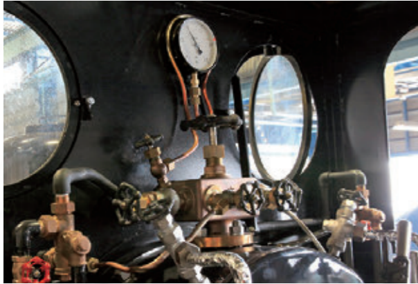
▼運転室の内部には圧力計や調整バルブが並ぶ
