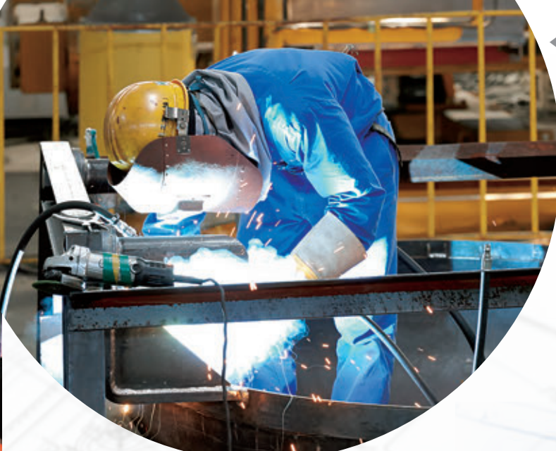
▲金属を局部的に溶融して、つなぎ合わせ製品にしていく
