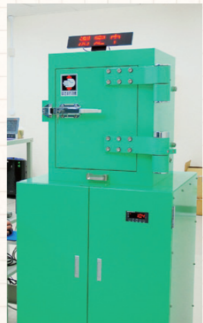
放射性物質を詳細に測定するゲルマニウム半導体検出器
