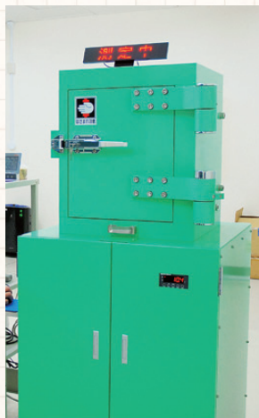
放射性物質を詳細に測定するゲルマニウム半導体検出器
