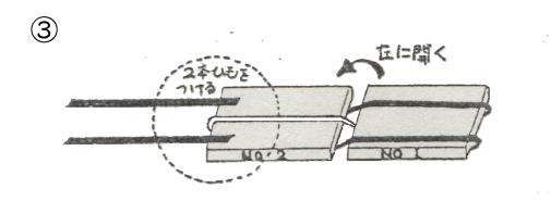
2 枚目の紙を左側に開き、2本のひもを図のようにつけ、 2 枚目が上にくるように右側に閉じる
