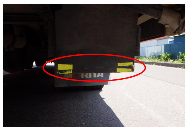
バランス一枠破損状況
