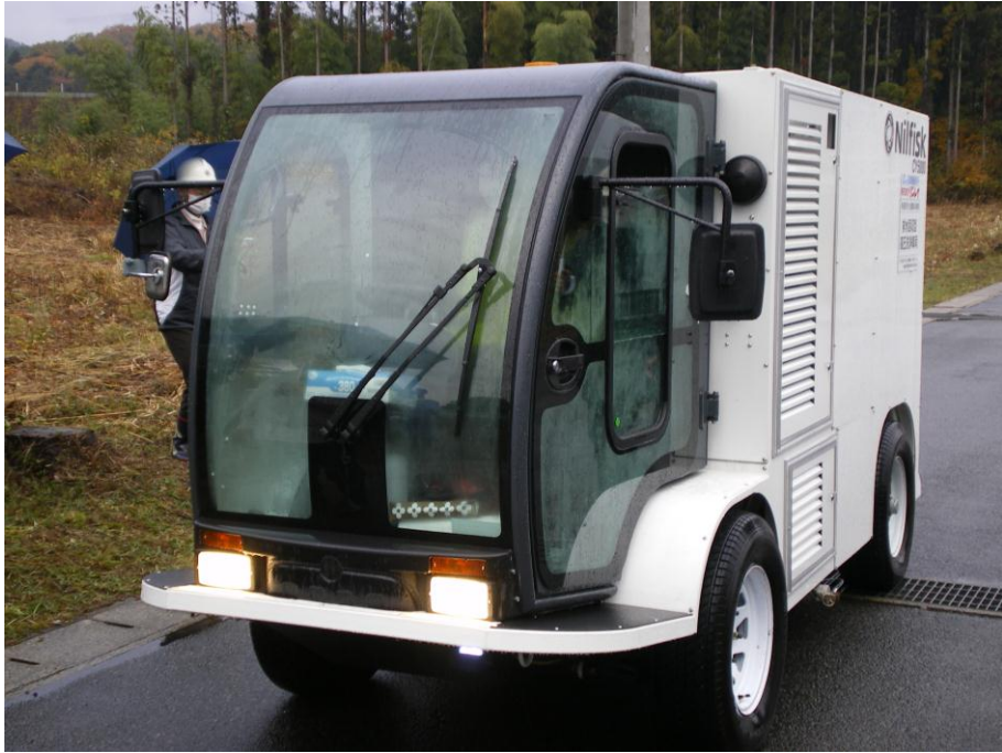
排水回収型の小型高圧路面洗淨車
