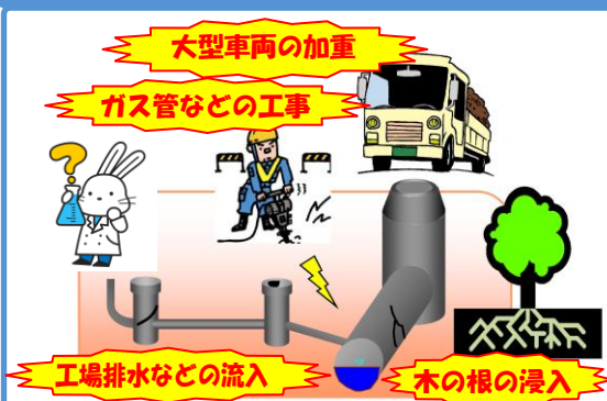
◆下水道管渠の劣化要因
