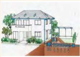
浸透性雨水樹・浸透性U字側溝
