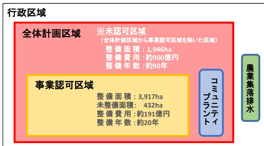
図 3 福島市における汚水処理施設の概要図(令和元年度末時点)
