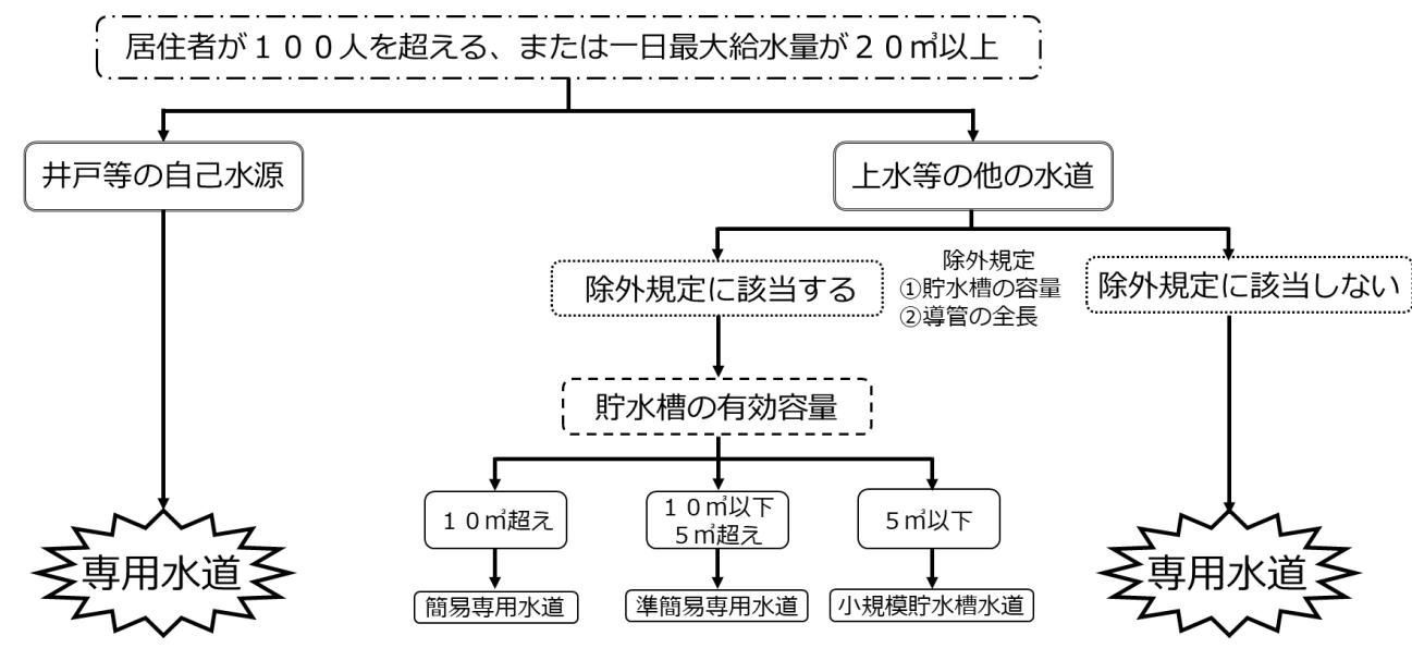
※1 導管の全長とは、地中又は地表（地表からの汚染の影響を受けない程度に高く設けられたものは除く）に敷設されている口径25mm以上の導管で、貯水槽から各棟までのすべての長さを加えたものを指します。貯水槽以前の給水装置及び建物内の縦管は含まれません。
