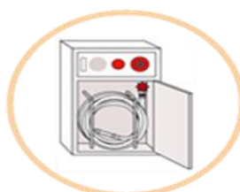
屋内消火栓設備
