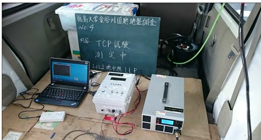
写真-5.3.2 PC、検層装置と定電力供給装置 (装置類は車内に設置)
