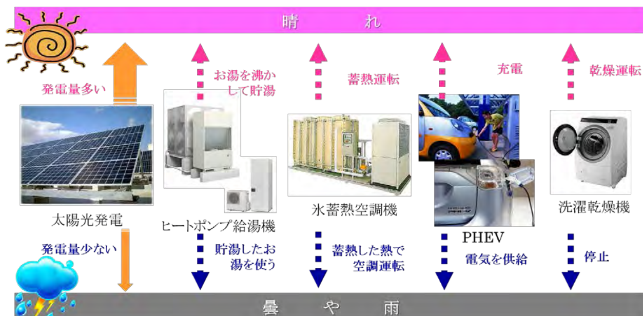
図 6.9.2 デマンドレスポンスによる蓄熱・蓄電の概念 (スマートコミュニティフォーラムにおける論点と提案)
