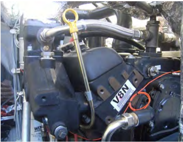
(a) エンジン部 (General Motors 社製, 4.3 L) エンジンオイル : 約 4ℓ 回転数 : 1500rpm
