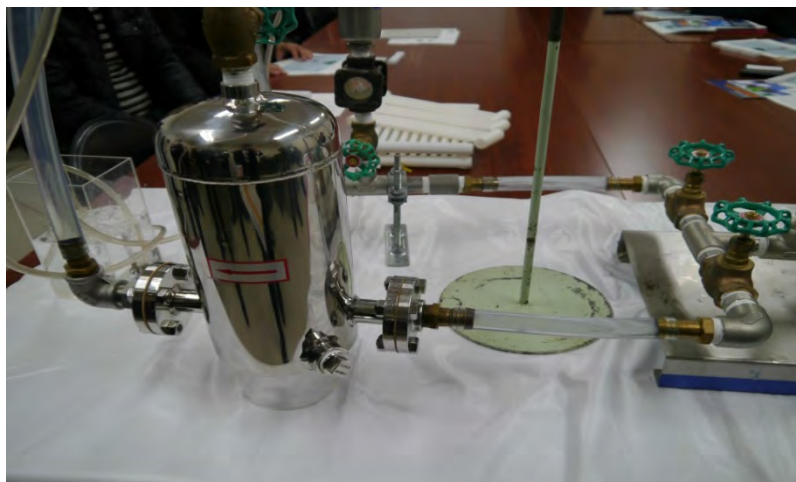
写真-1.7.4 KHKシルマー(高性能気水分離器)の実験モデル
