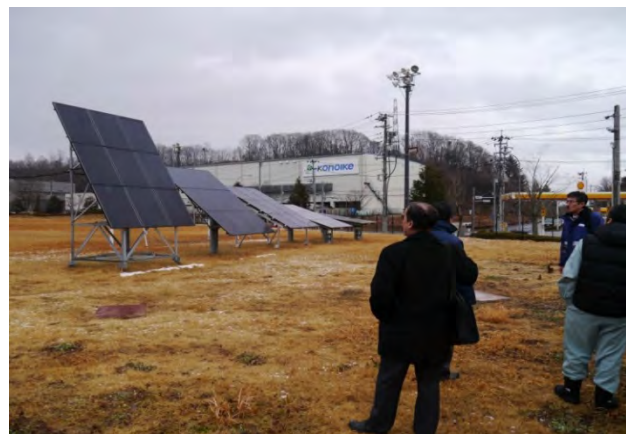
写真-1.2.5.2 斜度角度の異なる太陽光パネル 実証試験装置見学の様子
