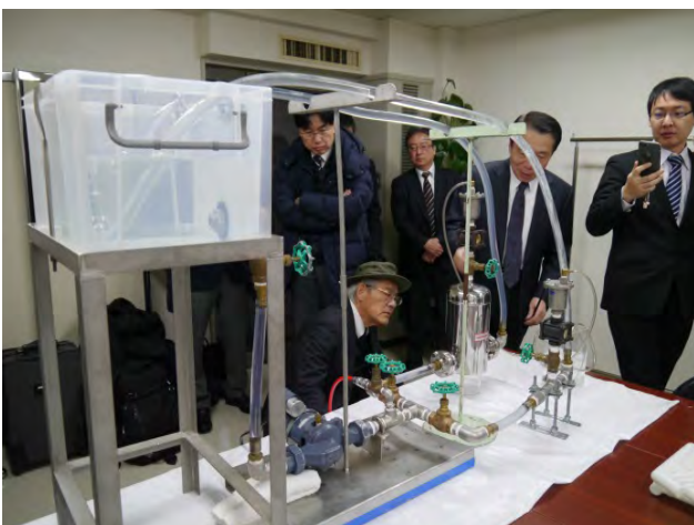
写真-1.7.3 KHKシルマー(高性能気水分離器)の実証試験の様子
