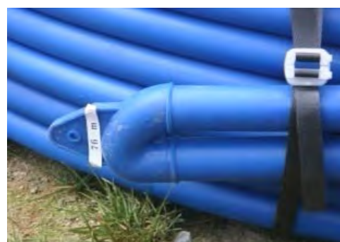
写真-2.3.4 地中熱交換器
