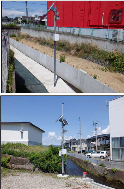
図 4-24 簡易型河川監視カメラ (上:鎌田樋管 下:会根田橋(祓川))
