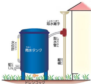
①貯留タンク
