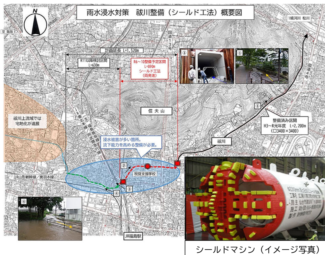
図 6-10 雨水渠整備の概要(祓川)
