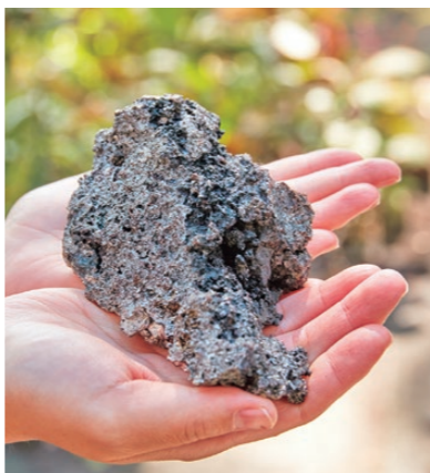
古刀を再現するため、たたら製鉄により古代製鉄炉で精錬された銑
