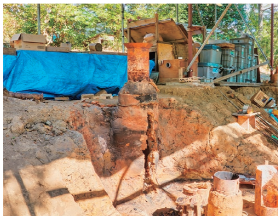
古刀再現の鍵は、鋼ではなく鉄の一種「銑」にあるのではないかと考え、南相馬市で発見された古代製鉄炉を仲間と共に再現。 壱型炉を作り砂鉄から銑を精錬するたたら製鉄にも挑んでいる。
