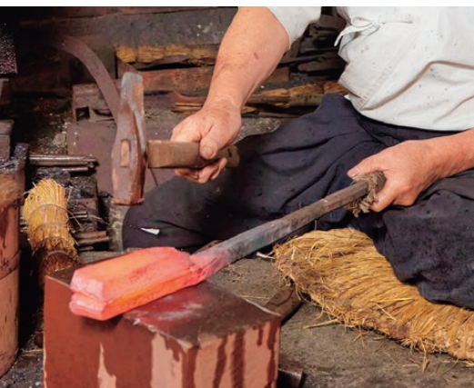
日本刀の作刀工程の一つ、火で鉄を鍛える「折り返し鍛錬」。これにより素材が均質化され強度が増す。
