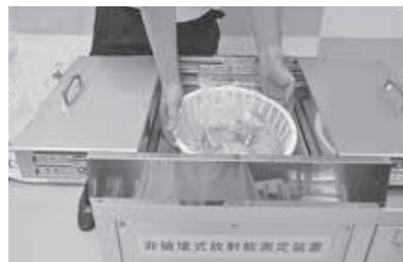
▲各測定所に設置した非破壊式放射能測定装置
