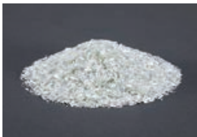
▲福島工場では主に硬質プラスチックの補強材に使用されている「チョップドストランド」を製造しています。
