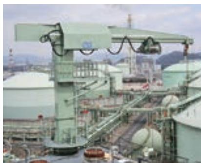
液化ガスを低温で大量に貯蔵するLNGタンク周辺は、電気設備などにより爆発や火災が起こる危険性があるため、電気などを使用しない空圧の当社LNGポンプ吊揚装置が使われています。汎用の空圧機械の技術を応用して作られている特殊クレーンで、この分野では特許を取得しています。
