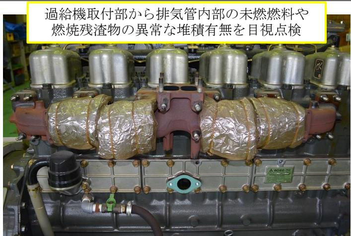
図2 排気管内部目視点検
