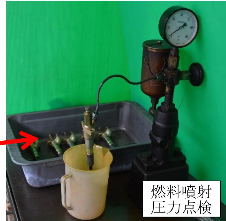
・燃料噴射弁を取り外し、作動させて、噴射状態と噴射圧力を確認する。
