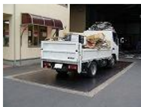
回収業等で料金の基となる 回収物の計量を行うはかり
