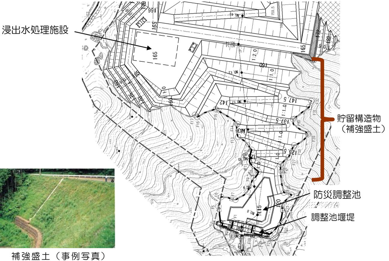
図8 貯留構造物 (平面)
