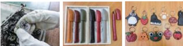
自動車部品の組立作業です。金属部品にゴムの部品を1つ1つ、はめ込む作業です。埃や汚れの付着や、部品の不良はないか、確認しながら作業をします。また、組立後も、個数や不良部品の最終確認を行います。
