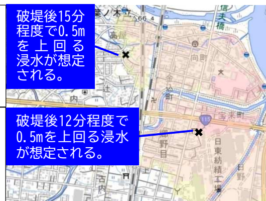
堤防が決壊（破堤）した場合の浸水深の時間変化②
