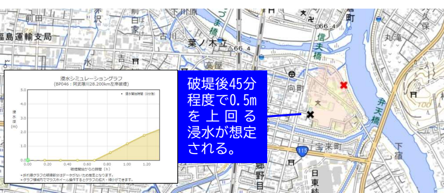
堤防が決壊（破堤）した場合の浸水深の時間変化③
