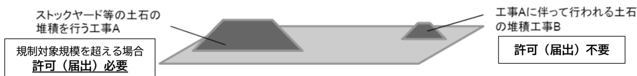
図 2.5.1 工事の施行に付随して行う土石の堆積
