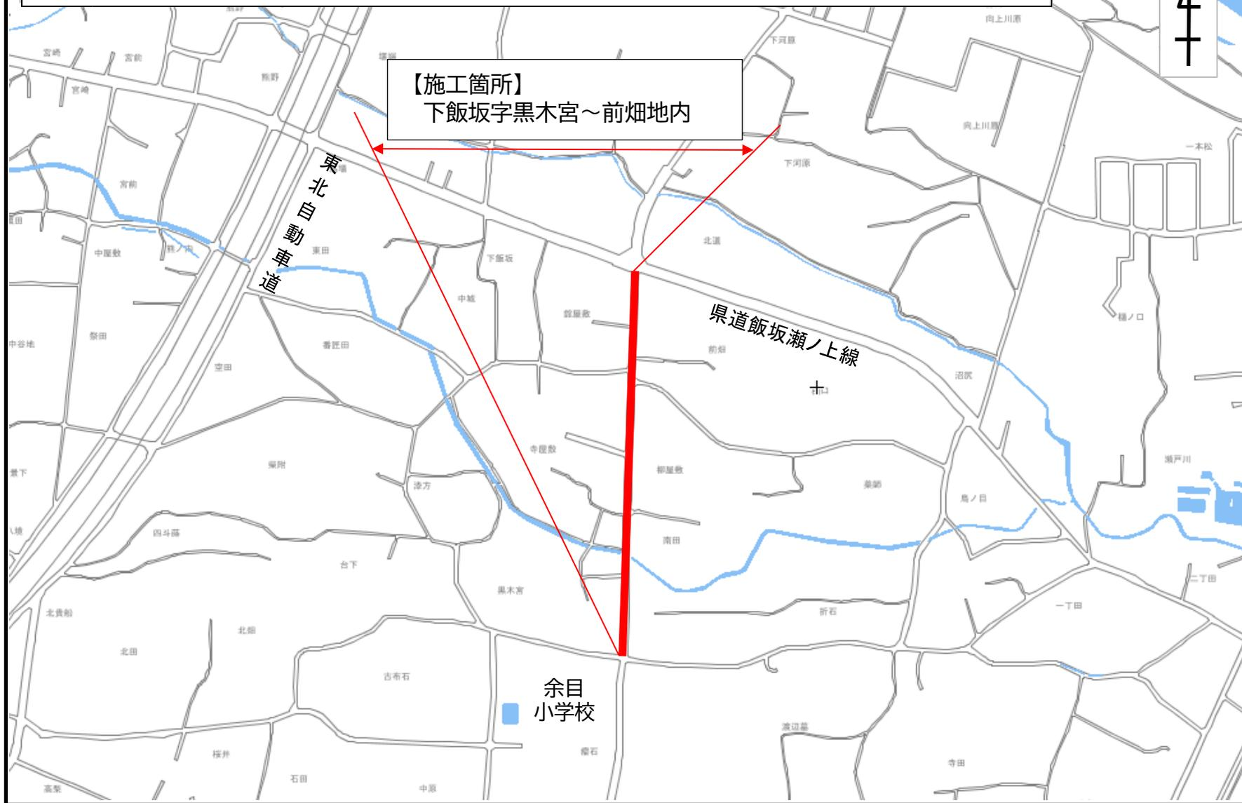
18 老朽管更新事業（第8期）に伴う上名倉第1幹線（第1-1工区）400mm配水幹線布設替工事
