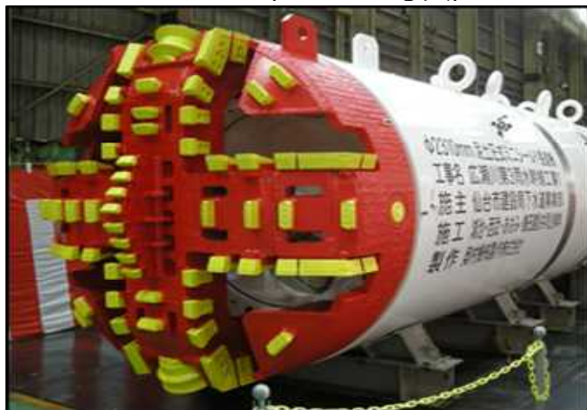
シールド掘削機：内径φ2000mm（先端部）
