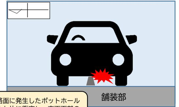
相手方車両が走行中、路面に発生したポットホールから剥離したアスファルト片に衝突し、車両下部のオイルパン等を破損した。
