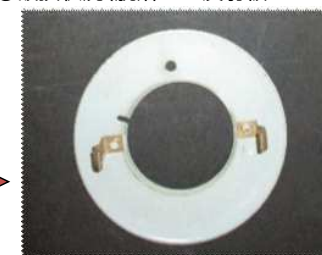
⑤破損状況(脱落した反射板ユニット)
