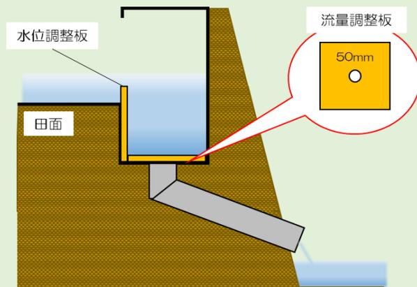
排水柵の底に、通常の排水口径より小さい、50mm程度の穴が空いた流量調整板を取り付け、水田からの排水を抑制する。
