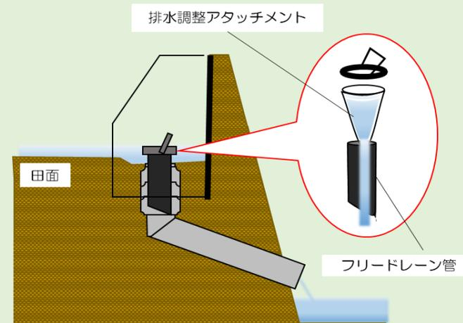
フリードレーン管に田んぼダム用のアタッチメントを取付け、水田からの排水を抑制する。
