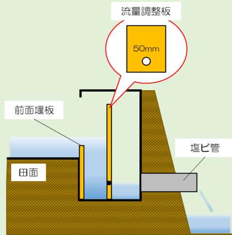
排水柵の角落しに通常の排水口径より小さい、50mm程度の穴が空いた流量調整板を取り付け、水田からの排水を抑制する。
