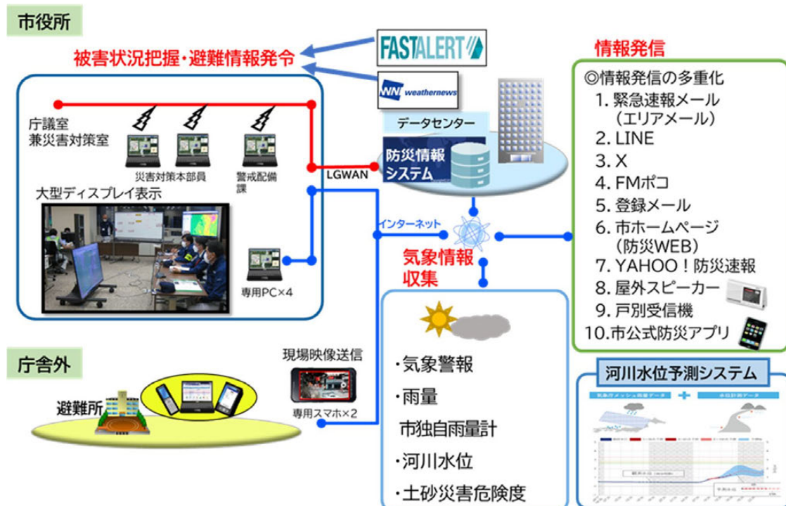
図 4-31 災害対策オペレーションシステム概要図
