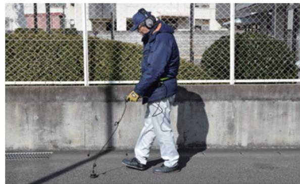
「水道管の漏水は水が無駄になるだけでなく、道路陥没などの事故につながることもあります」と言うのは、配水課漏水防止対策係の加藤豊さん。「日頃、『音聴棒』という地面の中の音を聞く道具などを使って、地下の水漏れがないかを調査しています。交通量の多い場所は周囲の音が影響しないよう、夜に調査する場合もあります。ペテラ
