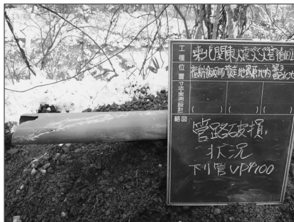
▲茂庭第3配水池系における配水管（VPφ100mm）破損箇所及び破損状況
