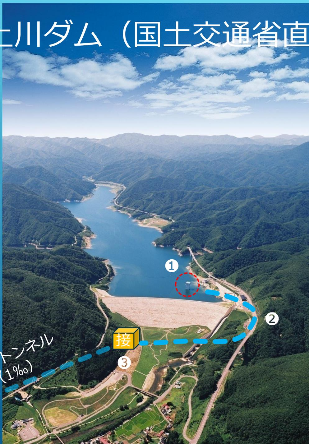
①取水塔（共同）：選択取水方式
