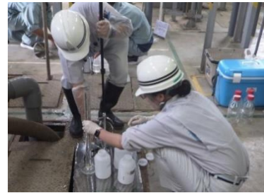
事業場排水の水質検査の様子
