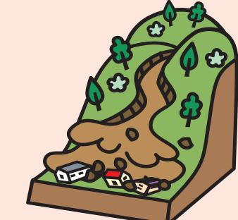
土石流は、大雨などで山がくずれ、くずれた土砂が水と一緒に流れたり、通りにある岩や木を巻き込んで津波のように流れてくるものです。
