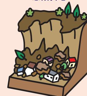
がけ崩れは、急な斜面が突然崩れ落ちる災害で、傾きが30度以上のがけは要注意です。
