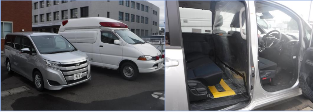
左：移送車両(救急車1台、飛沫循環抑制車1台) 右：運転席側と後部座席の間に隔壁を設置し、前方を陽圧、後方を陰圧とすることで後方の空気が前方に循環しない仕組みとなっている。
