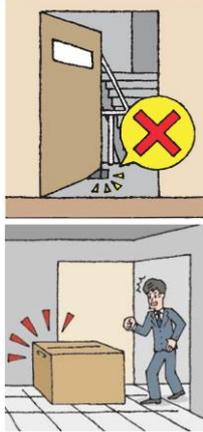
火災発生時、直通階段等を介して各階へ煙が拡散しないように階段室の防火戸等を適正に維持管理しましょう。
