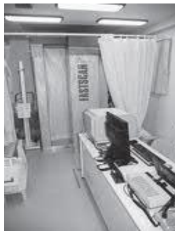
移動式ホールボディカウンタの内部
