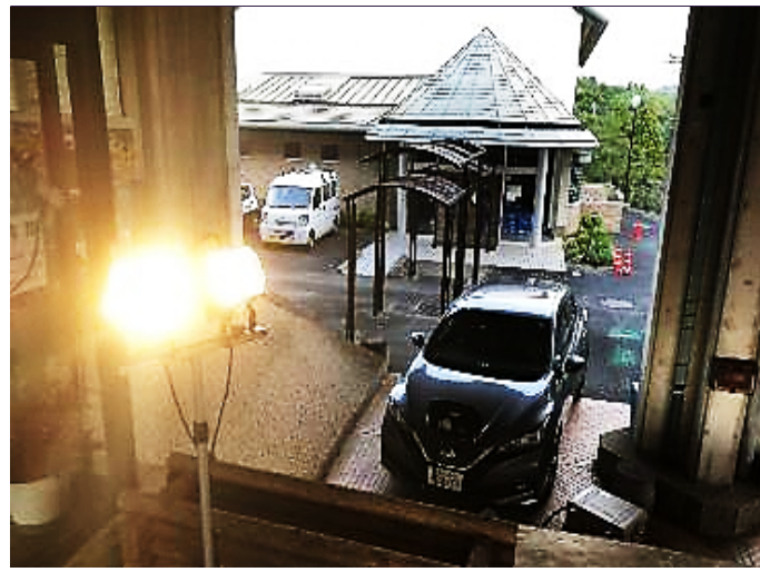
電気自動車による電源供給
