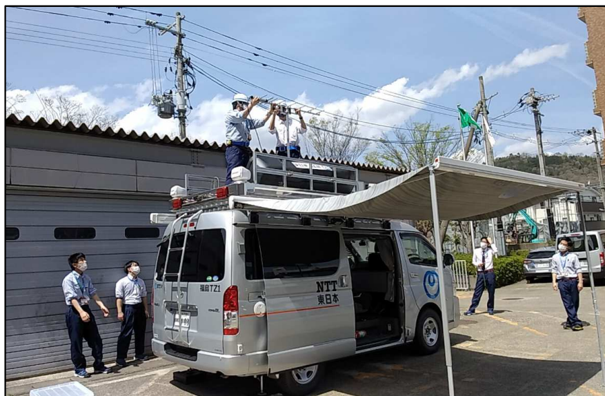
移動無線車から桑折町、二本松市との臨時回線確保
