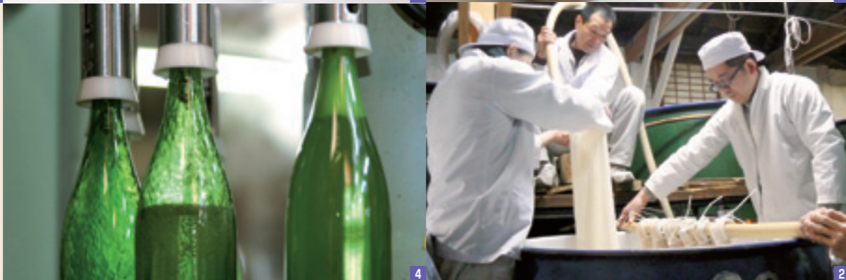
1 酒米は「五百万石」や「山田錦」、福島県のオリジナル酒造好適米「夢の香」などを使っています。ぜいたくに削られる酒米は、精米が高くなるほど球形に近づいていきます。精米歩合55%とは、玄米の表層部を45%削ることを言います 2 熟成した醪(もろみ)は、上槽(しほり)をして、酒と酒粕とに分けます 3 新酒の利き酒は、緊張の瞬間。青い蛇の目は、白い磁器に映る酒の清澄度(せいちょうど)や微妙な色合いを判断するための模様 4 丹精込めて造ったお酒が瓶詰めされる瞬間 5 最終工程「検瓶」。異物などが混入していないか光に透かして1本ずつチェックして出荷されていきます
