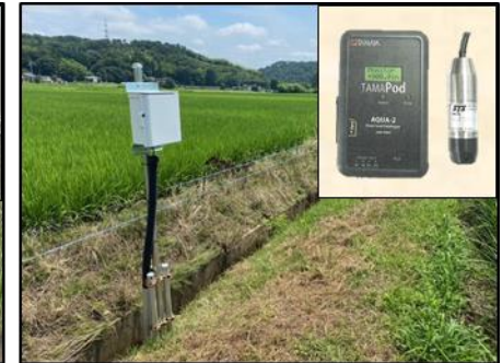
水位計設置状況
